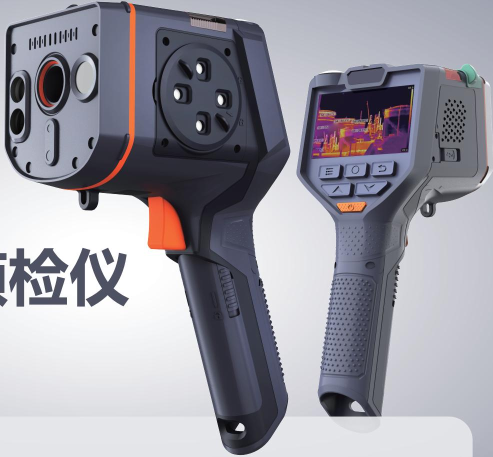
可视化多功能侦检仪集成红外测温、风速测量、红外热成像、可见光成像、红外测距、漏电检测、有毒气体检测等传感器于一体，具有多种功能。同时消防用多功能探测仪具有4G全网通、双频WIFI、蓝牙无线通信功能，支持北斗、GPS卫星定位。可视化多功能侦检仪能够把采集的数据实时传输到指挥中心，现场环境数据和图像可辅助指挥员指挥消防战斗，及时下达指令，提高消防救援效率。
